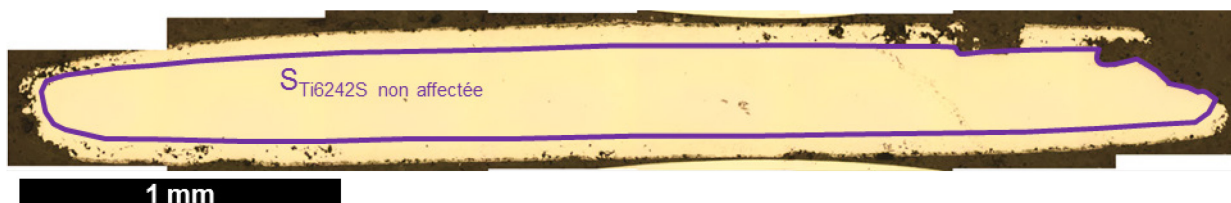
Figure V-12 : Représentation de la section de métal non affectée par l'oxydation avec NaCl S_{Ti6242S \text{ non affectée}}
