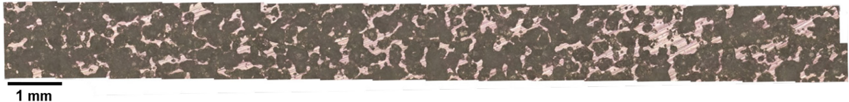
Figure IV-1 : Observation au microscope optique d'un dépôt couvrant de NaCl
