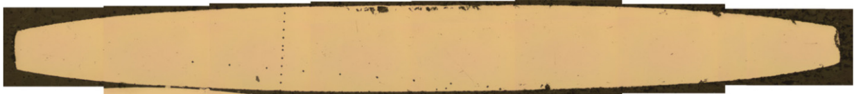
Figure II-13 : Observation post-mortem au microscope optique de la section d'une éprouvette de Ti6242S oxydée 1 000 h sous air
