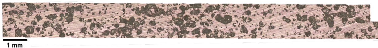
Figure IV-32 : Observation au microscope optique d'un dépôt de 1 \text{ mg/cm}^2 de NaCl
