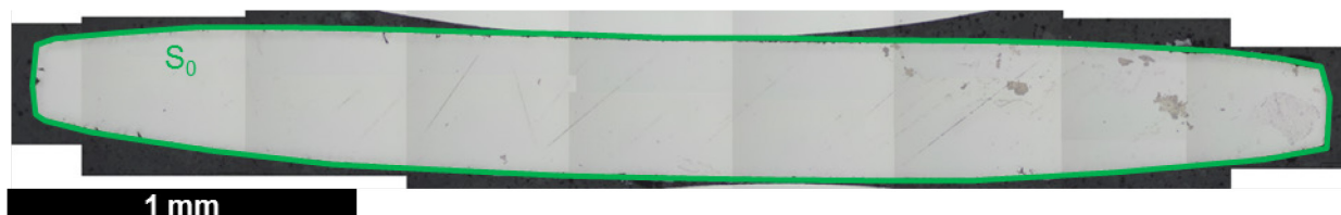
Figure V-21 : Représentation de la section initiale S_0 de l'éprouvette oxydée 100 h avec le dépôt \text{NaCl}/\text{Na}_2\text{SO}_4
