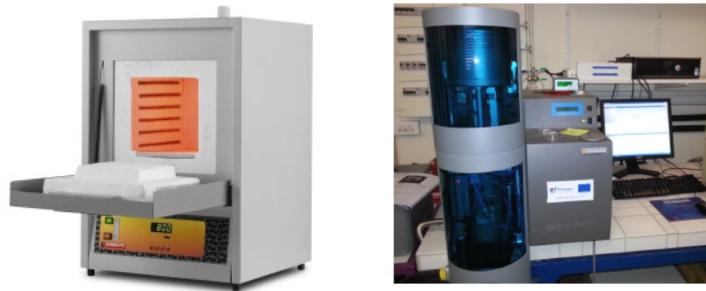
Figure II-4 : Four Carbolite (à gauche) et thermobalance SETSYS Evolution (à droite) utilisés pour l'oxydation sous air de laboratoire
