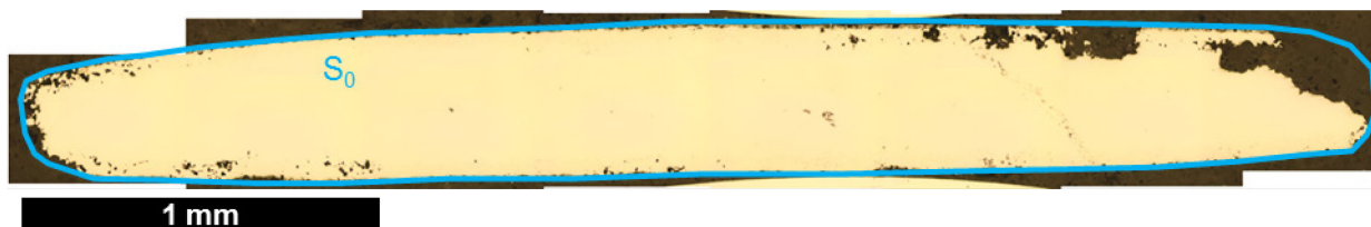
Figure V-9 : Observation au microscope optique de la section rompue de l'éprouvette oxydée 100 h avec dépôt de NaCl
