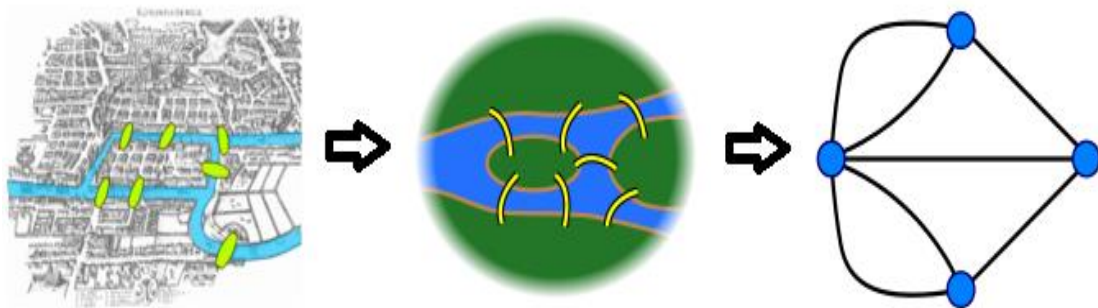
Figure 16 : Représentation du problème des sept ponts de Königsberg sous la forme d'un graphe
