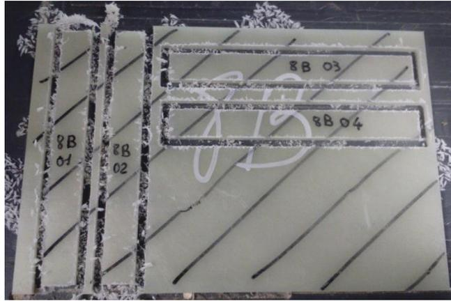
Figure 5.22 : Zones de découpe des éprouvettes prélevées sur une plaque de flexion (90 x 135 mm<sup>2</sup>) selon deux directions en position 1, 2, 3 et 4.
