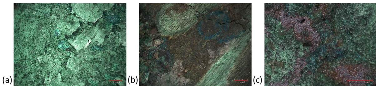
Figure C.2 23 – Prises de vue sous microscope optique de différentes zones de bronze. (a) et (b) sur le fragment n°6 (barre d'échelle 1000 µm) et (c) sur le fragment découpé n°9 (barre d'échelle 500 µm).
