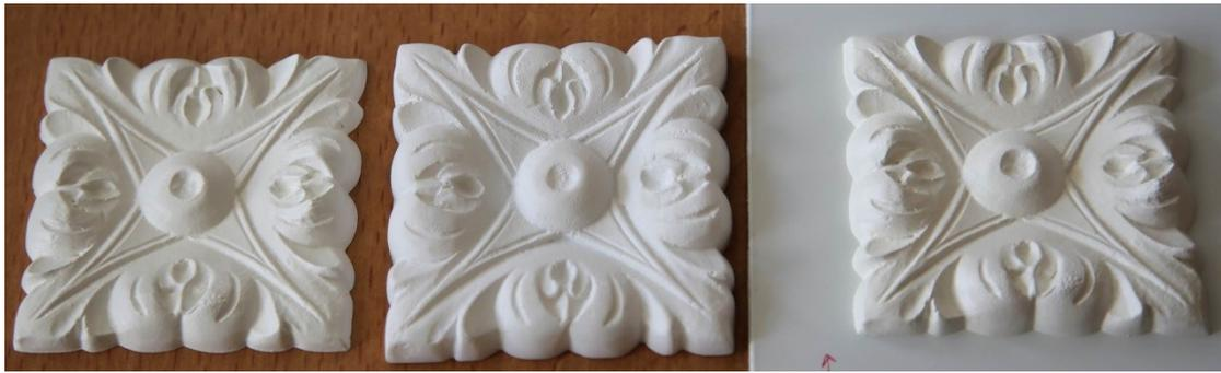
Figure C.2 4 – De gauche à droite : imprimé mat à piliers, objet original, et imprimé sans piliers.
