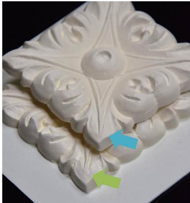
Figure C.2 5 – Imprimé mat placé sur l'imprimé plus brillant. Sous cet éclairage, même si cela n'est pas idéalement rendu par la photographie, on voit la différence entre les reflets brillants de l'imprimé normal, signalés par la flèche verte, qui sont absent de l'imprimé à micro-structure, signalé par la flèche bleue.
