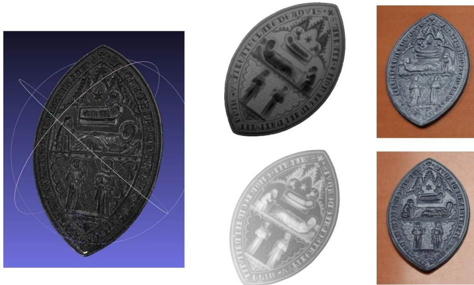
Figure C.2 47 – Scan 3D, cartographies des hauteurs et imprimés réalisés (en plein et en creux) pour la matrice de sceau n°115.
