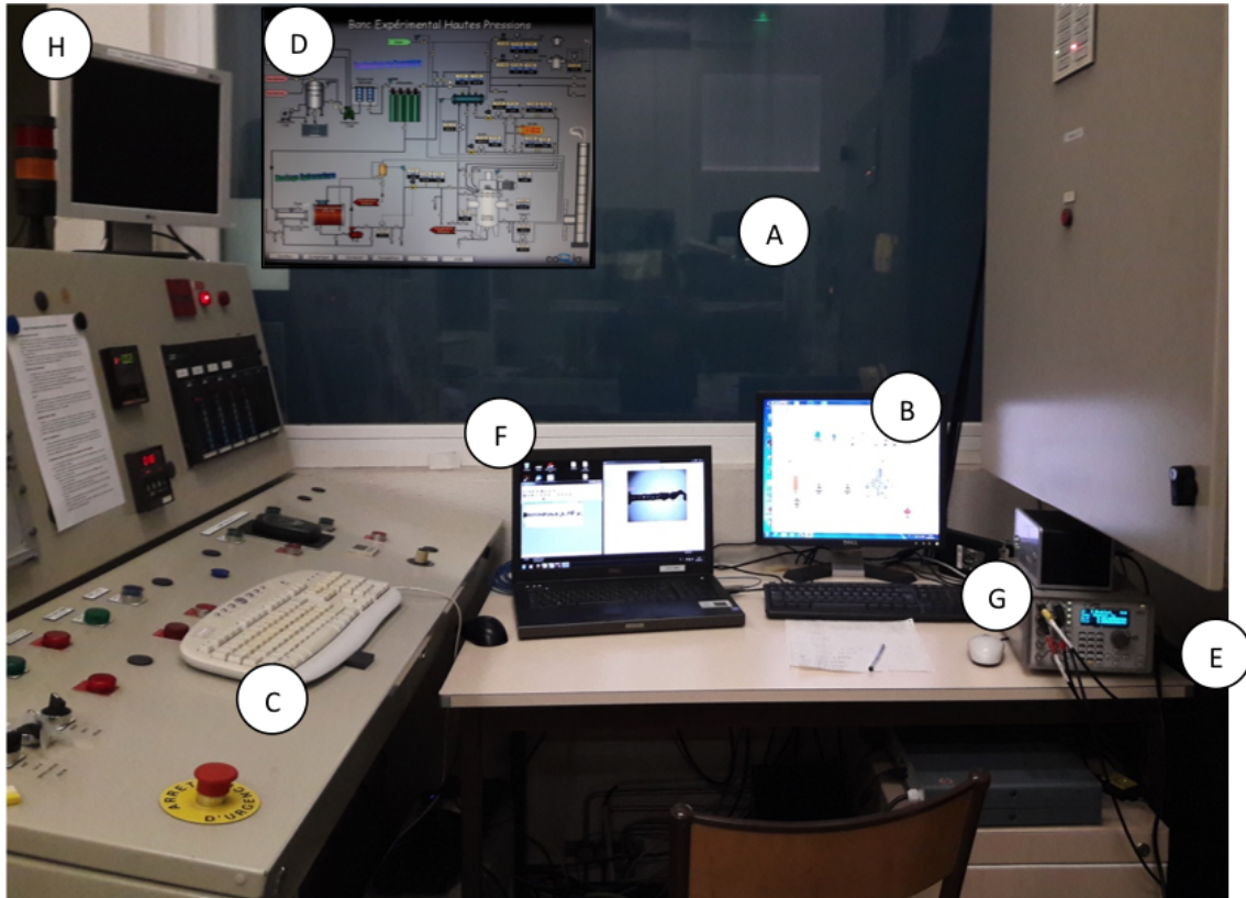
FIGURE II.16 – Poste de commande du banc d'essai REFINE. (A) : vitre anti-déflagration donnant sur le banc ; (B) : écran de contrôle avec l'interface labview (Fig. II.17) et le contrôle du déplacement de l'injecteur ; (C) : ancien pupitre remplacé par l'interface VisualIO (D) ; (E) : commande manuelle de pression de N_2 ; (F) : écran de contrôle des caméras ; (G) : générateur de retard ; (H) : écran de contrôle de la source rayons X.
