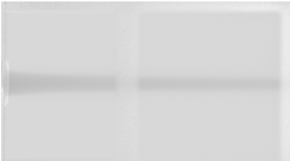
FIGURE IV.40 – Exemple d'une radiographie, sur 22 mm, d'une injection de \text{C}_2\text{H}_6 à 0.27 \text{ m.s}^{-1} dans du He à P_{ch} = 5.5 \text{ MPa} et T_{ch} = 293 \text{ K} (14/06/2017 Annexe A).
