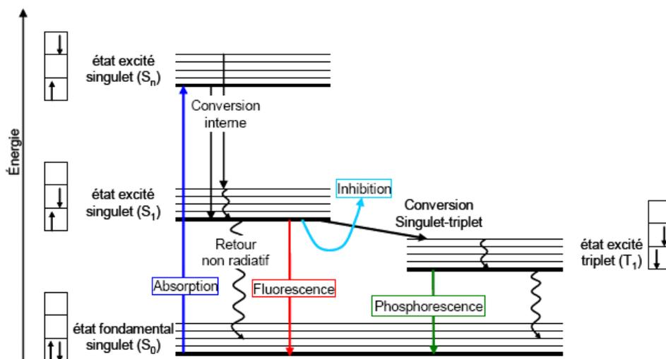
Figure 2 : Diagramme de Perrin-Jablonski<sup>4</sup>
