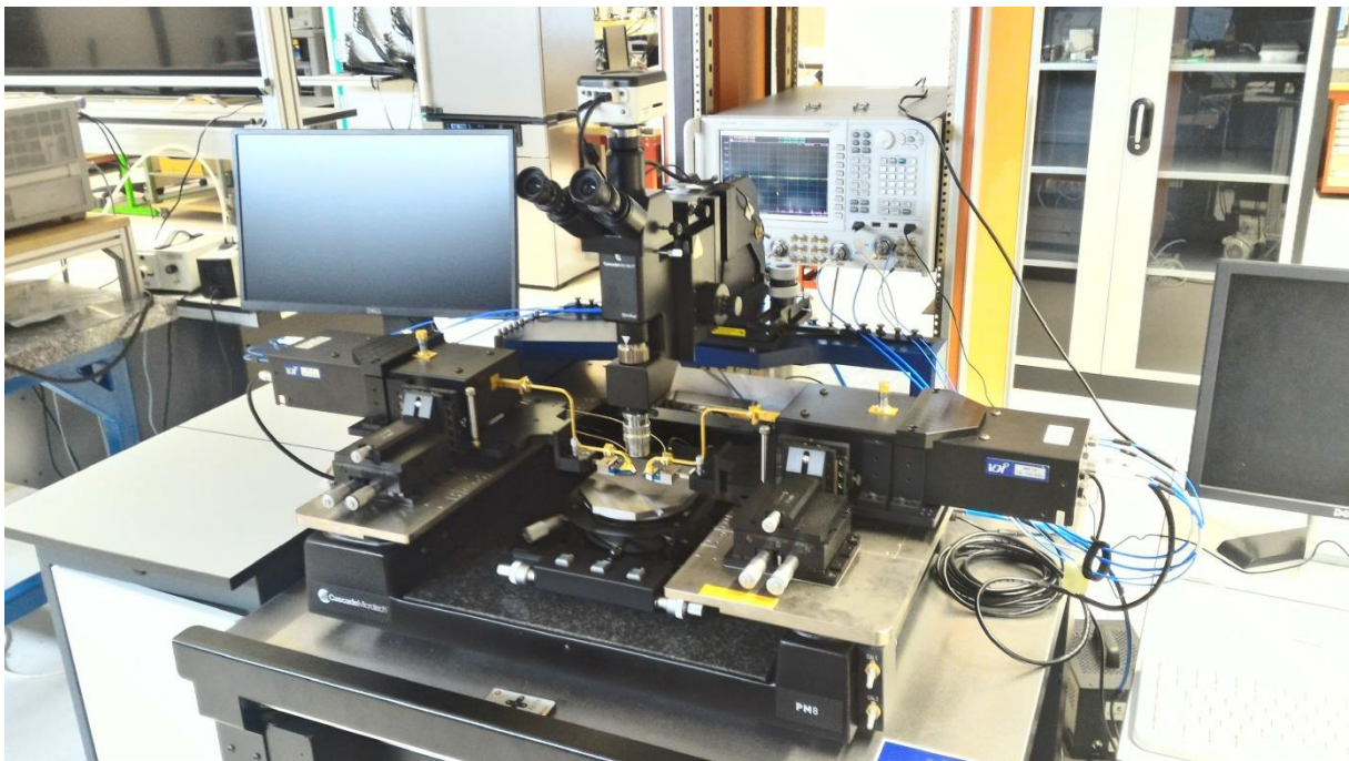
Figure 82 : Banc de mesure pour la bande de fréquence 70-110 GHz.
