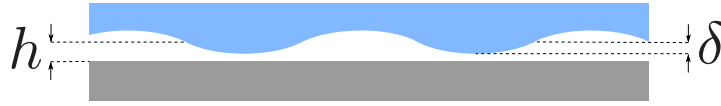
FIGURE 4.5 – Onde de surface à l'interface liquide-vapeur sous la goutte, quand l'amplitude \delta de l'onde est comparable à l'épaisseur h du film de vapeur.
