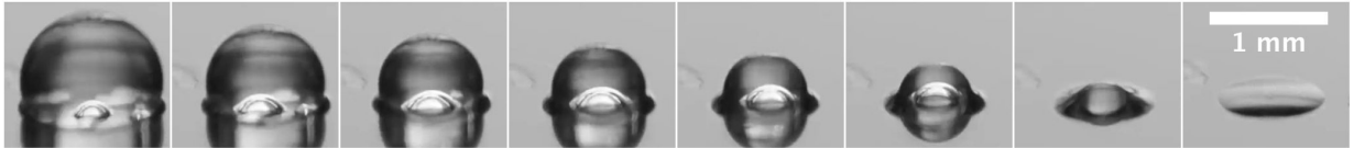
FIGURE 6.9 – Evaporation d’une goutte d’eau de 4\mu\text{L} posée sur une surface lubrifiée chauffée à 71^\circ\text{C} . La vapeur produite forme des bulles sous la goutte. L’intervalle de temps entre deux images est de 16 secondes.
