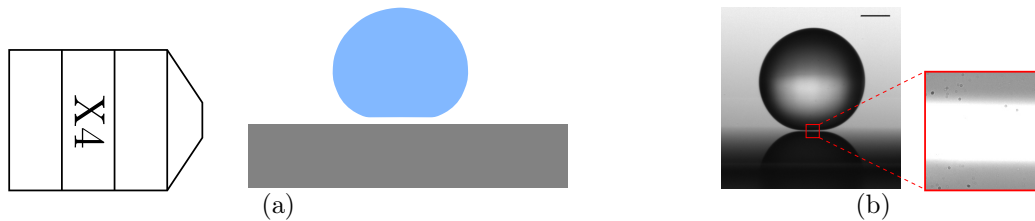
FIGURE 4.10 – Visualisation directe du film de vapeur d'épaisseur h . (a) Un objectif de microscope est approché du bord d'une goutte caléfiée rétroéclairée. (b) On est donc capable d'observer le film de vapeur de côté. L'épaisseur de la bande blanche est égale à 2h puisque l'on voit sur cette image à la fois le bas de la goutte (en haut) et sa réflexion (en bas).
