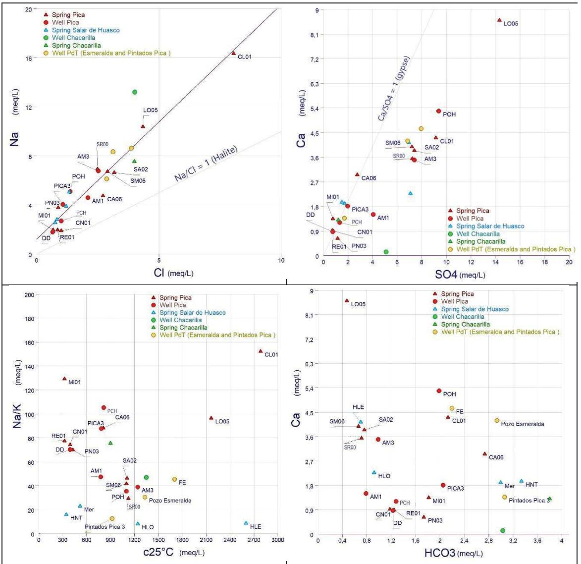
Figure 40: Diagrammes binaires Na-Cl, Ca- $\text{SO}_4^{2-}$ , Na/K-Conductivité et Ca- $\text{HCO}_3^-$  des sources, galeries souterraines et forages des bassins versants de Quisma, Salar de Huasco, Chacarilla et bordure orientale de la zone centrale de la Pampa del Tamarugal (réalisés avec le logiciel Diagramme de l'Université d'Avignon).
