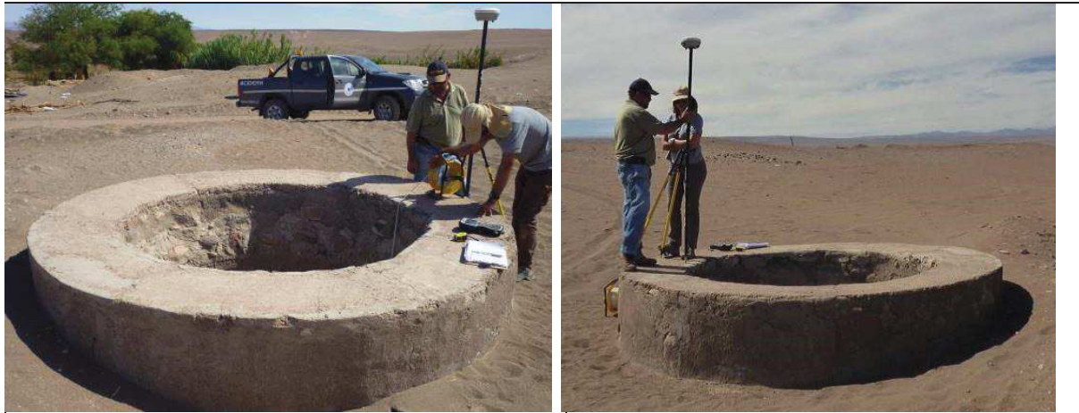
Figure 25 : Relevé topographique d'un puits de l'aquifère PdT
