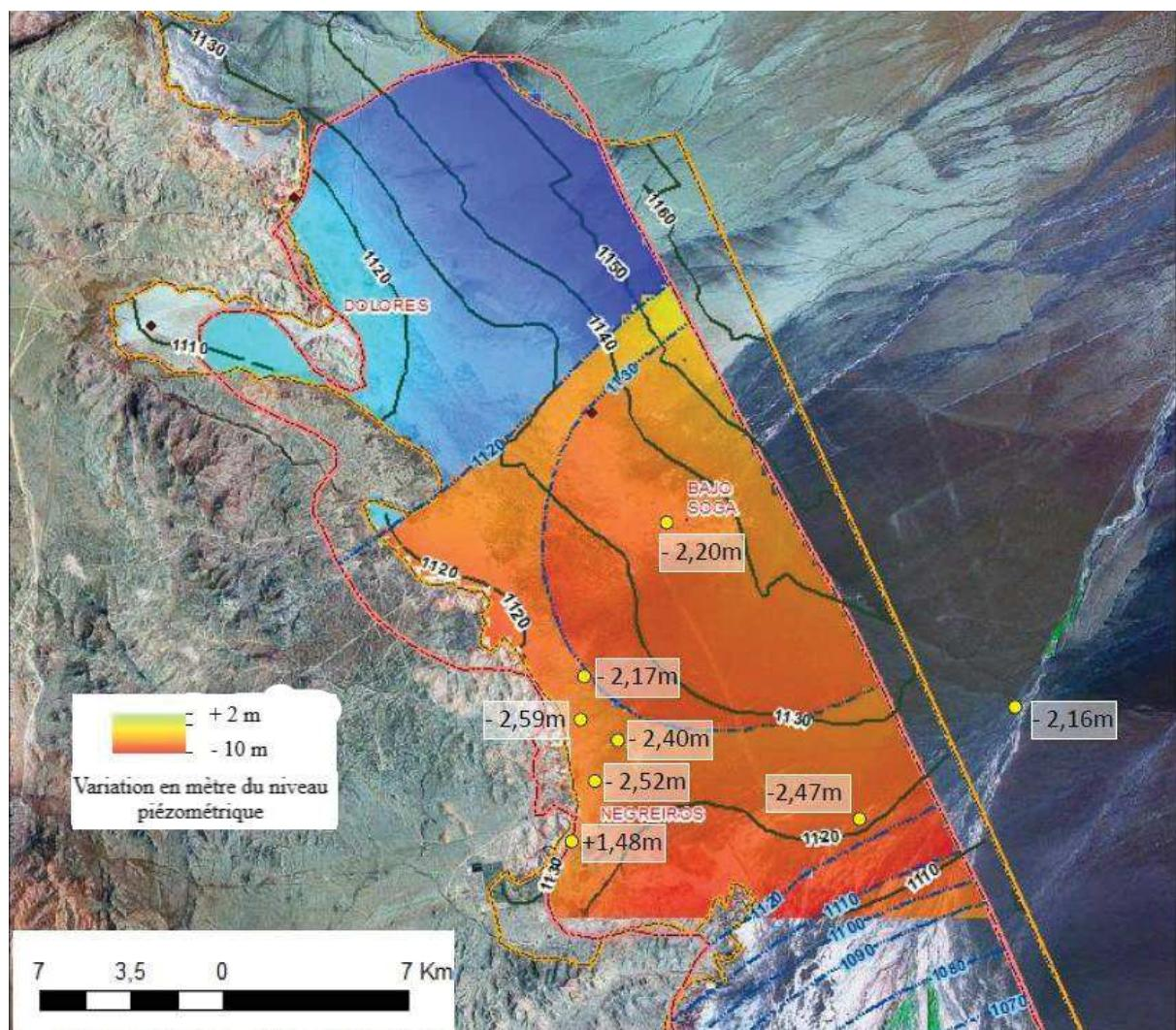
Figure 31 : Différences piézométriques entre les campagnes de 1995 et 2013 dans la partie nord de l'aquifère PdT (les points jaunes représentent les forages qui ont été mesurés en 1995 et 2013. Le chiffre indique la baisse du niveau piézométrique entre ces deux dates)
