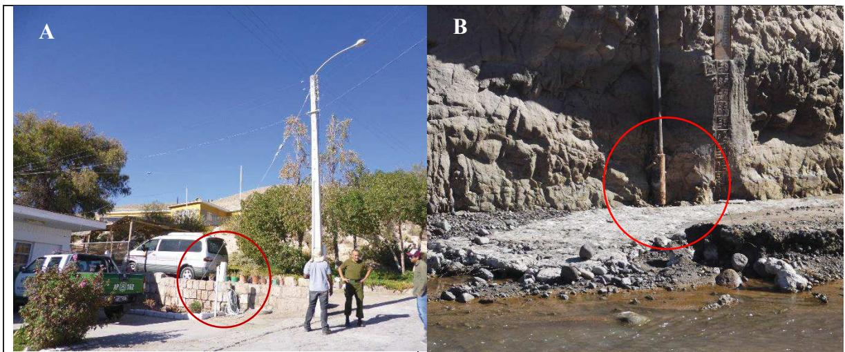
Figure 7: Exemples d'une station pluviométrique (A) et de jaugeage (B) de la Région de Tarapacá
