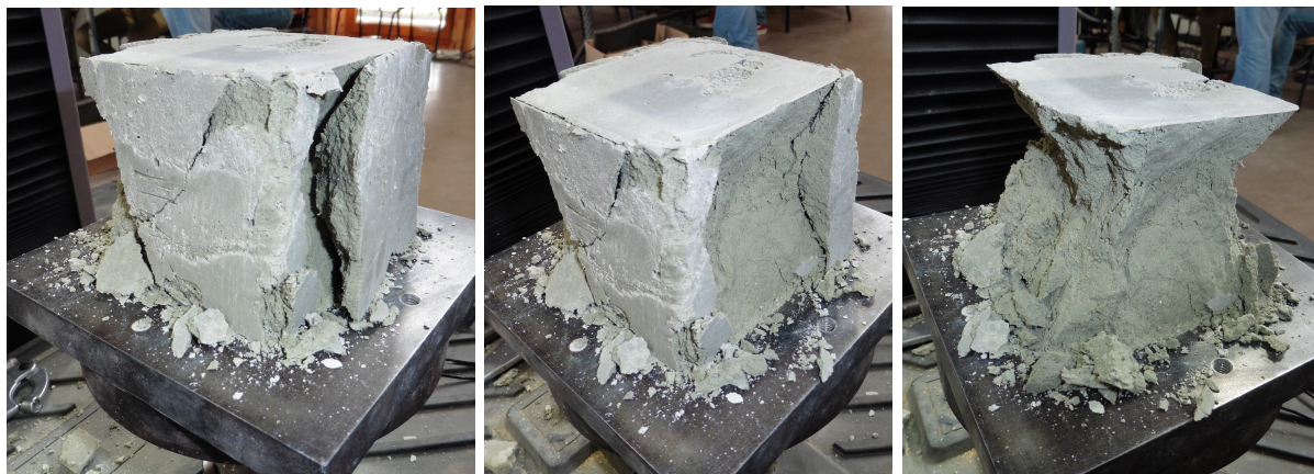
Figure 4-1 : Photographies d'une éprouvette après un essai en compression
