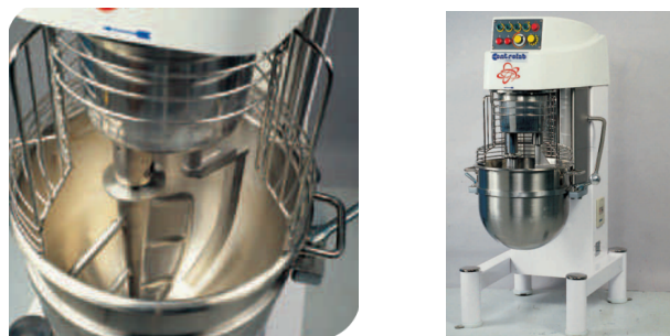
Figure 2-6 : Malaxeur à rotation planétaire utilisé dans le cadre de nos travaux
