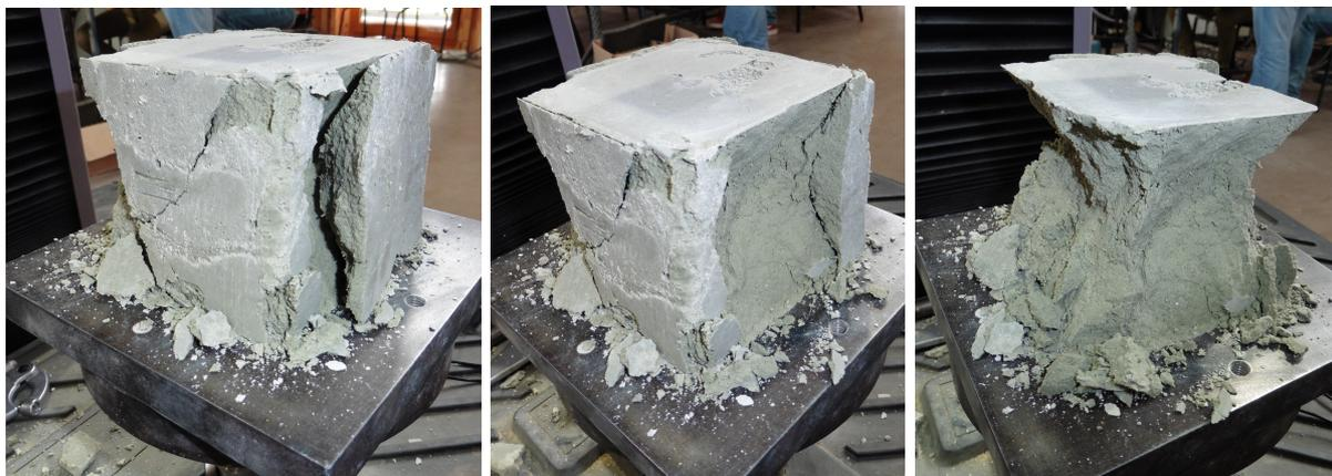
Figure 4-1 : Photographies d'une éprouvette après un essai en compression
