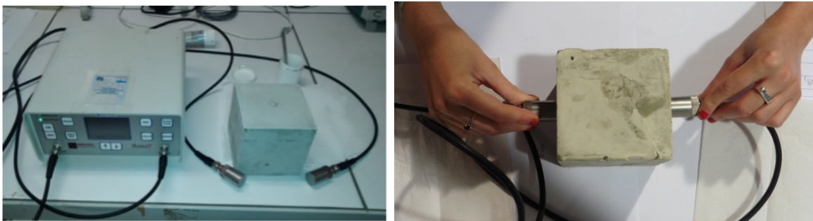
Figure 2-11 : Photographie du système de mesure des ultrasons
