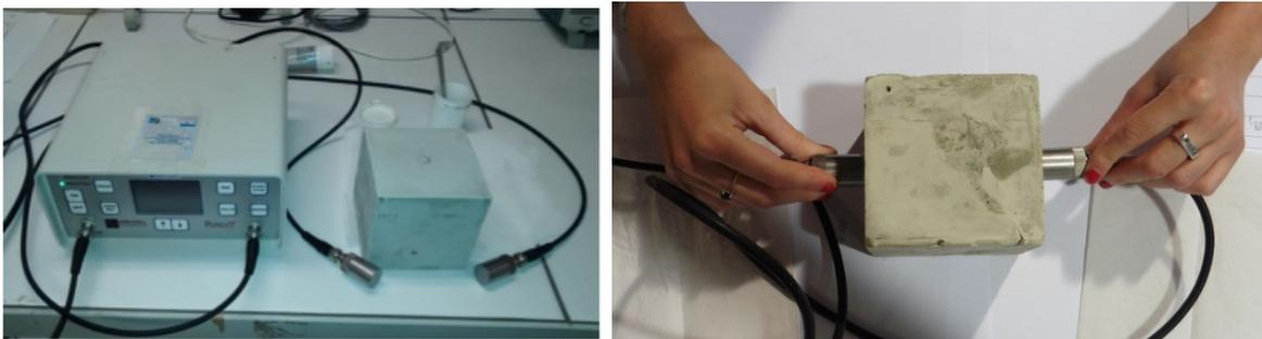
Figure 2-11 : Photographie du système de mesure des ultrasons
