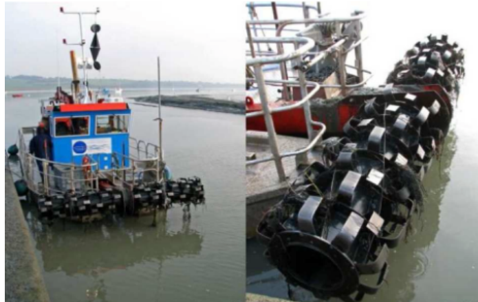
Figure B-5 : Rotodévaseur « Le Rochevilaine » utilisé dans l'estuaire de la Vilaine (Sigwald R., 2012)
