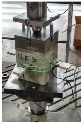
Figure 2-8 : Positionnement des 4 extensomètres en déformation longitudinale
