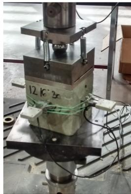
**Figure 2-8 : Positionnement des 4 extensomètres en déformation longitudinale**
