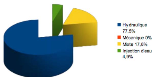
Figure C-1 : Utilisation des différentes techniques de dragage dans les Grands Ports maritimes en 2009 (Le Guyader, 2012)
