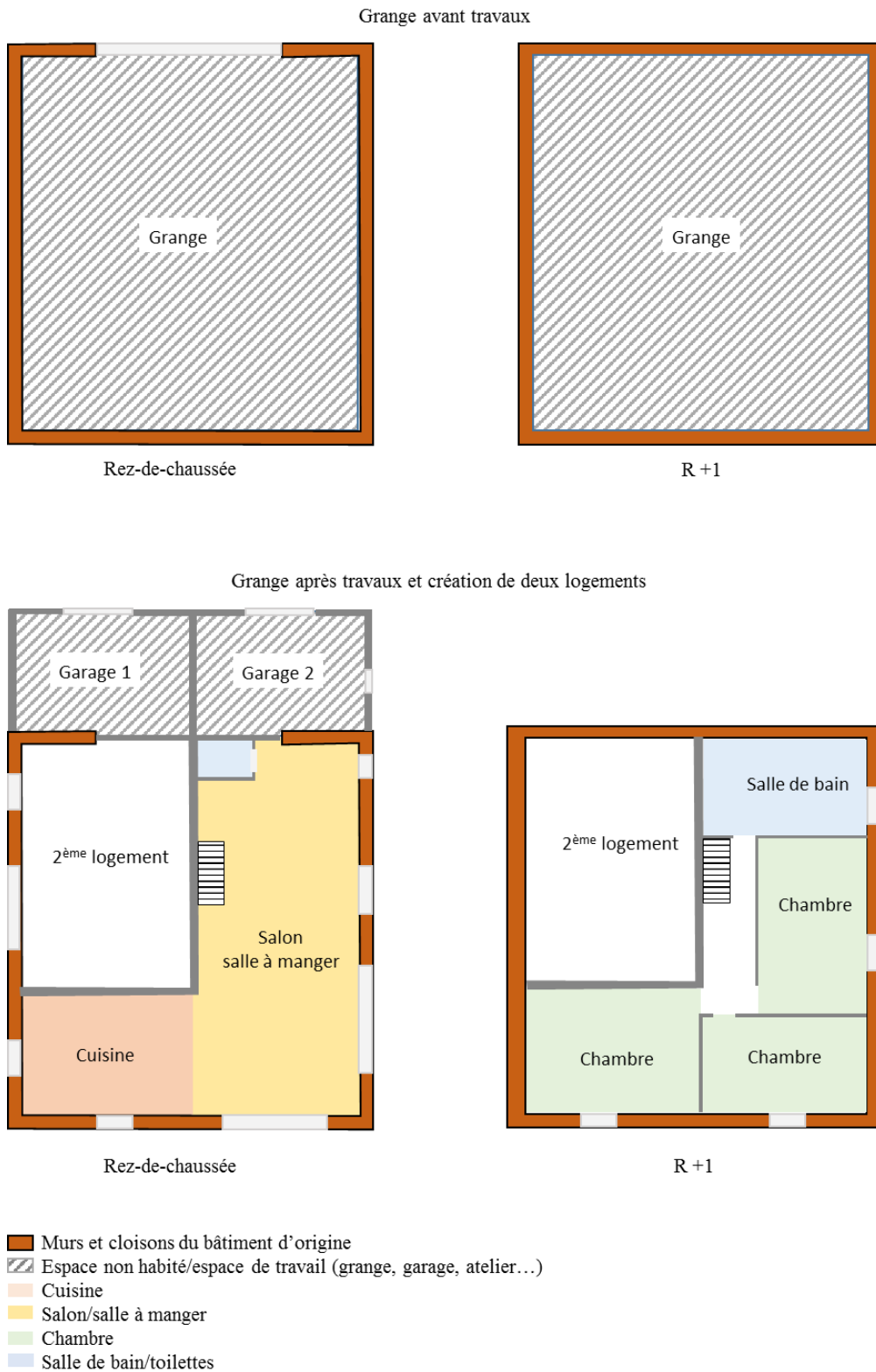
Figure 24. Plans schématiques des transformations du bâti lors de la réhabilitation réalisée par Sabine et Maxime : de la grange à l'aménagement de deux logements.
