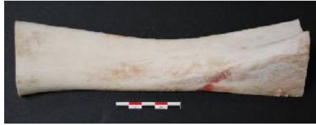
Fig. 88: Échantillon d'os « bouilli » (tibia de bovidé) contre l'émeri à T0.
