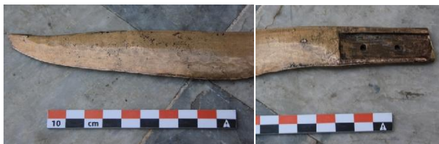
Fig. 84: Test 3, pierre à aiguiser, à affûter naturelle crétoise grand format face B contre la lame en bronze alliage 10% d'étain (© C. Roos).
