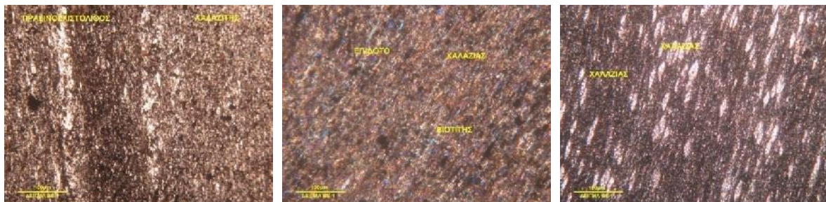
Fig. 50: Résultat de l'analyse pétrographique sur le 1 er échantillon de roche provenant de Belgique (coticule) (© IGME).
