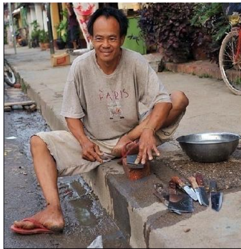
Fig. 36: Affûtage de couteaux à l'eau sur une pierre utilisée en mode passif au Laos (Asie). Photographie © youngman242 (avril 2009).
