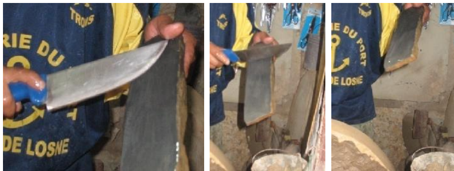
Fig. 61: Pierre naturelle employée pour l'affûtage d'une lame de couteau à Fès (Maroc) (© H. Procopiou).
