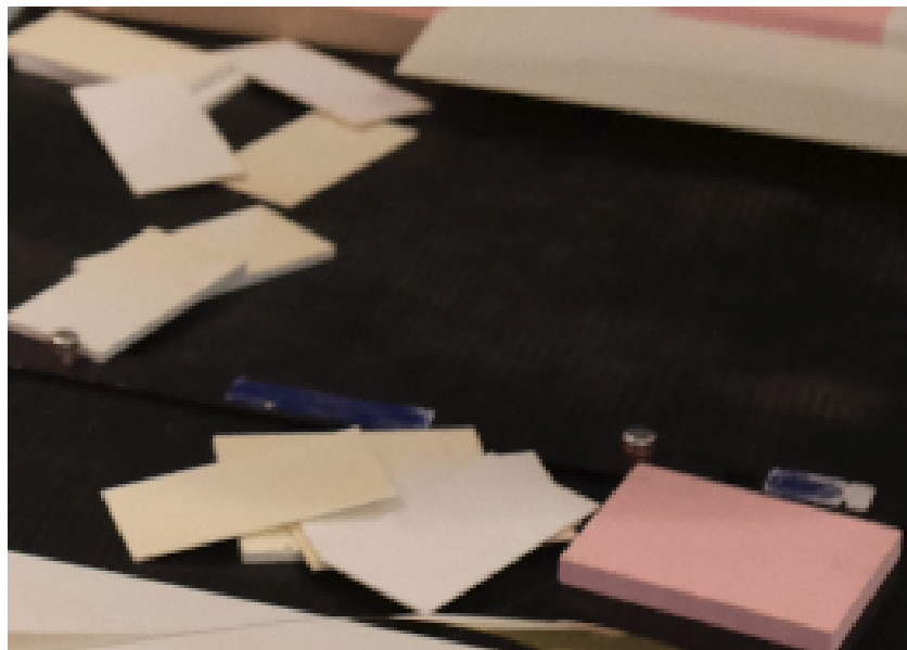
FIGURE 5.2 : Photographie des fantômes utilisés. Les fantômes d'eau sont en blanc, et ceux du poumon en rose.
