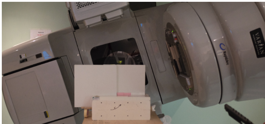
FIGURE 5.4 : Disposition du montage expérimental. L'accélérateur sera cependant placé à 90^\circ dans l'axe de l'entrefer et non penché comme présenté ici.
