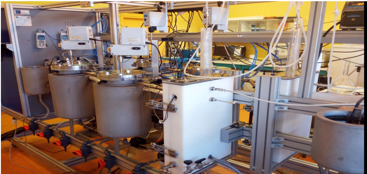
Figure 2.3 : Pilote Bàm 3 (Bàm anaérobie à membrane immergée)
