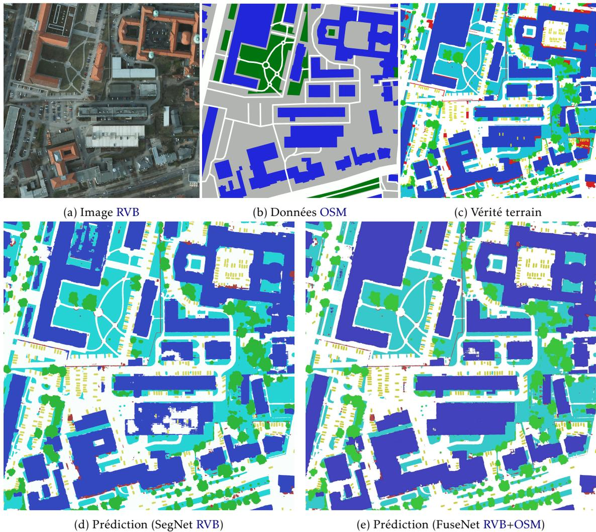
FIGURE 5.11 – Exemple de segmentation obtenue sur le jeu de données ISPRS Potsdam en incluant la donnée OSM. Les erreurs sur les bâtiments sont grandement réduites.
