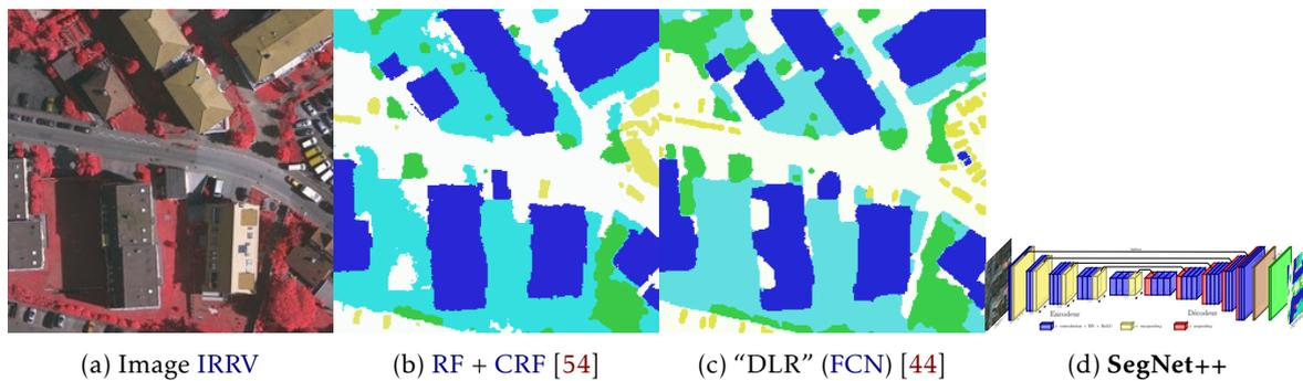
FIGURE 3.12 – Comparaison des segmentations obtenues sur un extrait du jeu de test ISPRS Vaihingen. Légende : blanc : routes, bleu : bâtiments, cyan : végétation basse, vert : arbres, jaune : véhicules, rouge : autre.
