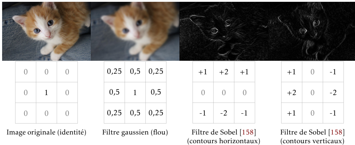
FIGURE 2.5 – Exemples de filtrages par différents noyaux de convolution.
