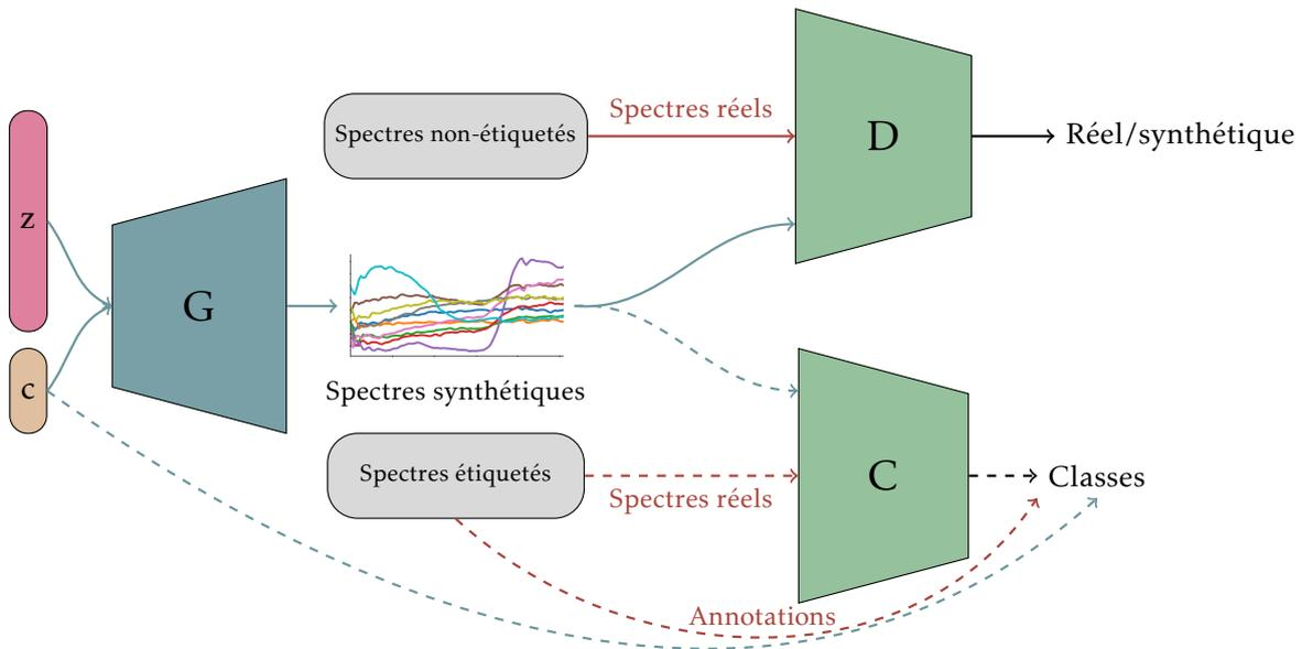
FIGURE 6.1 – La structure du GAN utilisé pour la synthèse de spectres artificiels. Les flèches en rouge indiquent l’entraînement du classifieur et du discriminateur, tandis que les flèches en bleu indiquent l’entraînement du générateur. Les flèches en pointillé indiquent les connexions qui ne sont utilisées que dans le cadre supervisé.
