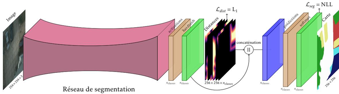
FIGURE 7.12 – Apprentissage multitâche (classification pixel à pixel et régression des cartes de distances). Les couches convolutives sont en **bleu**, les activations non-linéaires en **vert** et les cartes d’activation en **marron**.
