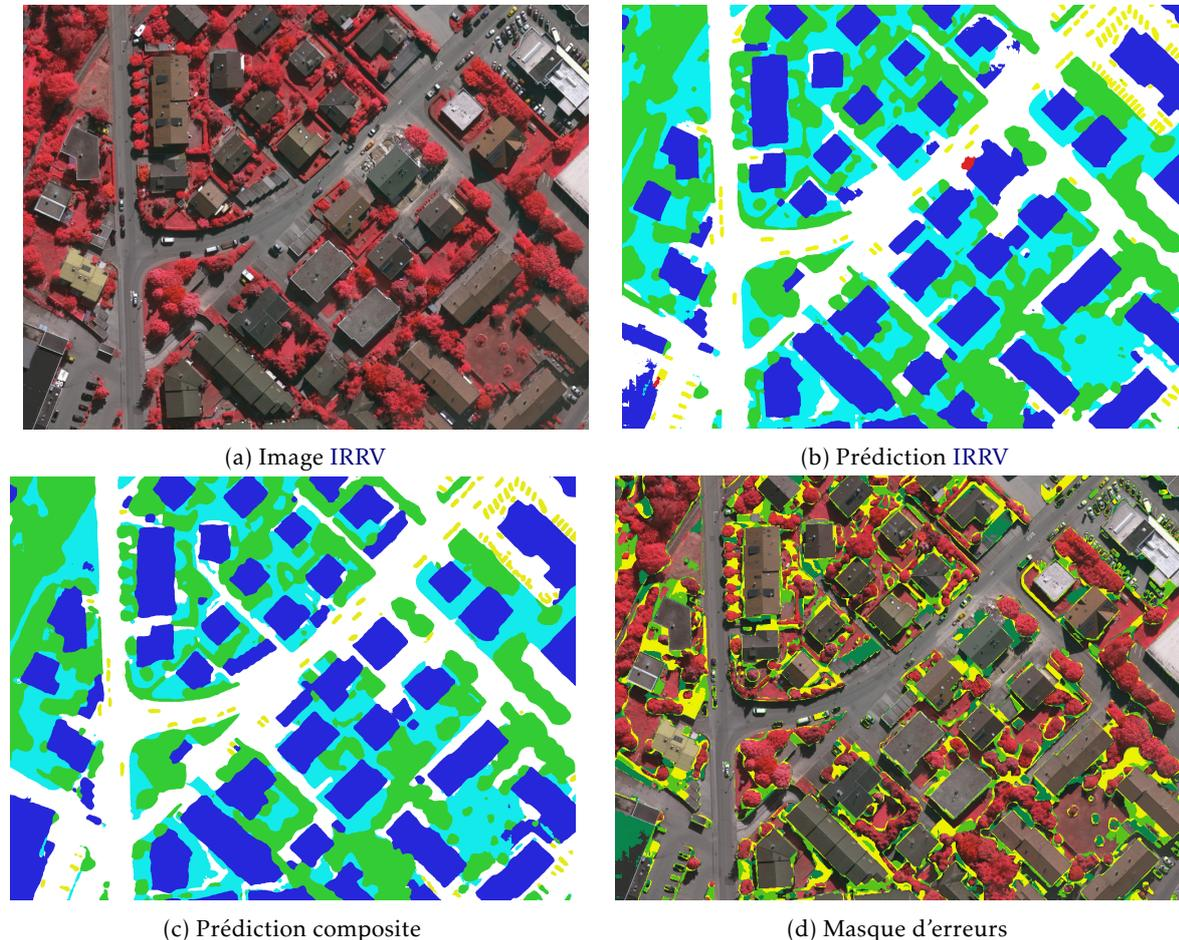
FIGURE 4.11 – Différences entre les prédictions des modèles IRRV et composite. (b),(c) Légende : blanc : routes, bleu : bâtiments, cyan : végétation basse, vert : arbres, jaune : véhicules, rouge : autre. (d) En vert clair les erreurs du modèle entraîné en composite, en vert foncé les erreurs du modèle entraîné en IRRV et en jaune l'intersection des deux masques.
