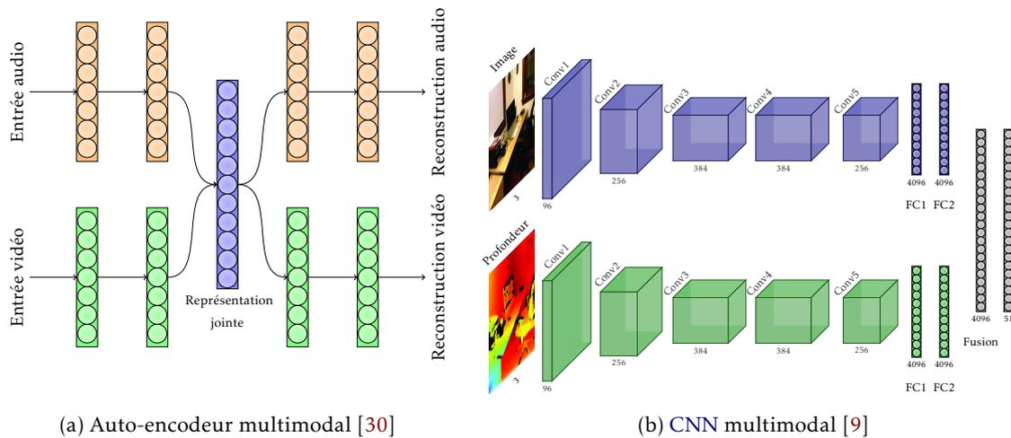
FIGURE 5.1 – Exemples d'architectures multimodales de réseaux profonds.
