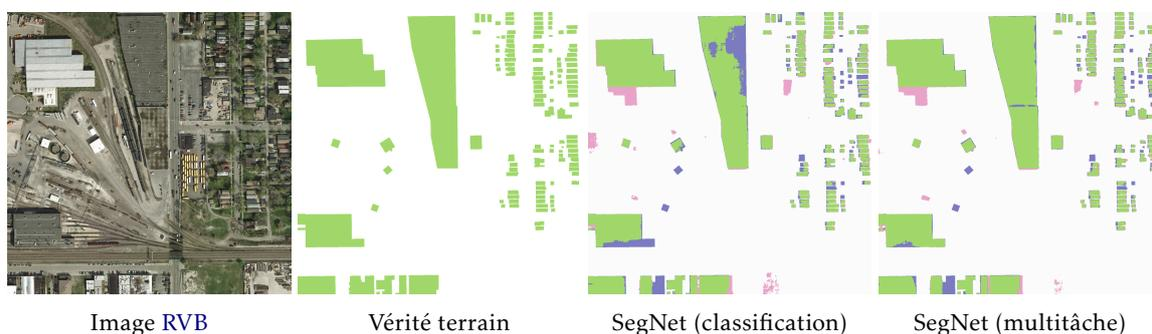
FIGURE 7.15 – Extrait des résultats de segmentation sur le jeu de données INRIA *Aerial Image Labeling*. Les pixels corrects sont en vert, les faux positifs en rose et les faux négatifs en bleu. L’approche multitâche capture mieux la structure spatiale des objets.
