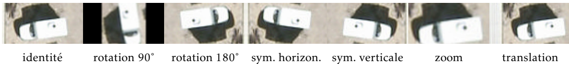
FIGURE 7.3 – Augmentation de données sur un véhicule de la base VEDAI.
