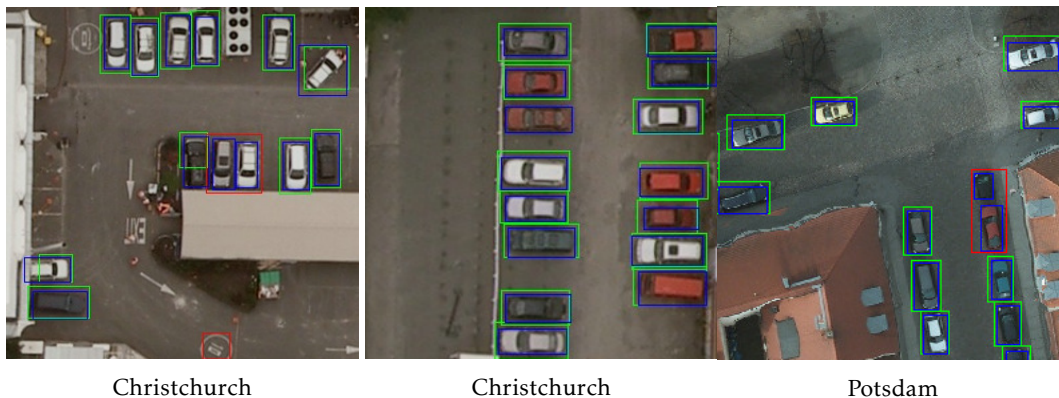
FIGURE 7.6 – Exemples de détections sur Potsdam et Christchurch (vrais positifs en vert, faux positifs en rouge et vérité terrain en bleu).
