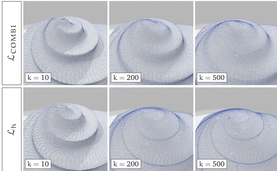
Figure 6.9 Lissage par l'opérateur de Laplace–Beltrami discret \mathcal{L}_h avec k = 10, 50, 200 . L'image en haut à gauche correspond à la surface discrète initiale nommée OctaFlower.
