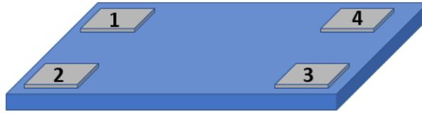
Figure I-51: Schéma d'un échantillon contacté pour des mesures d'effet Hall
