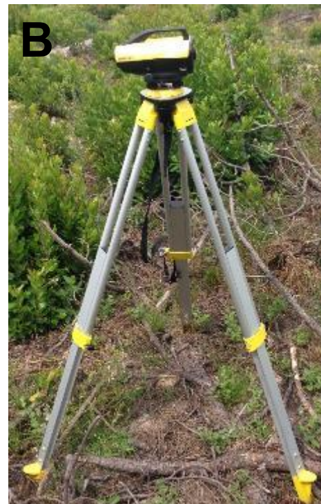
Photo 4 : Outils de mesures utilisés pour: A) le micro-relief; B) les mesures d'altitudes. (source : A. Guignabert)
