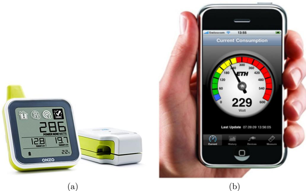
FIGURE 1.2 – (a) Smart Energy Kit pour la rétroaction de la consommation électrique [gadgetreview, 2015]; (b) Retroaction fourni par l’application eMeter [Weiss et al., 2013]
