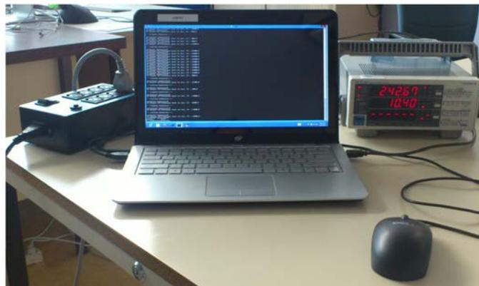
FIGURE 3.7 – Installation de l'Ultrabook avec le Yokogawa WT210
