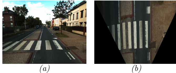
FIGURE 1.11 – Exemple d'application de la transformée perspective inverse – (a) Image originale - (b) Image simplifiée.
