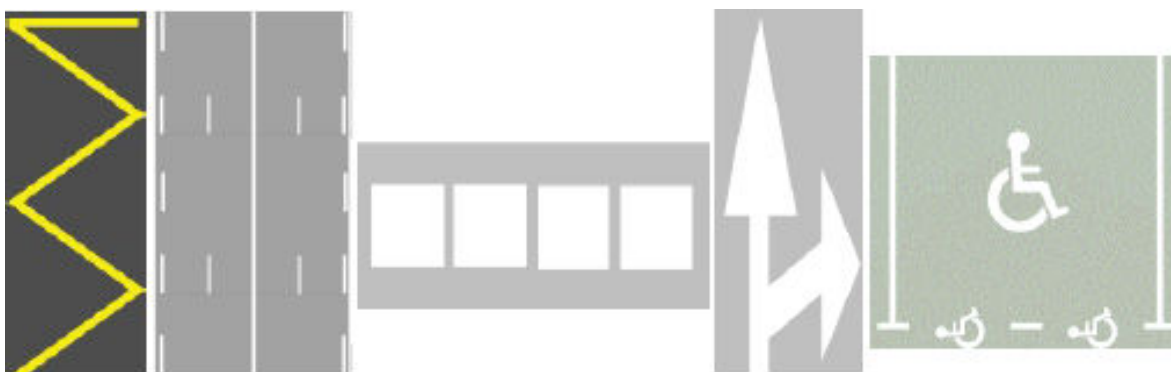
FIGURE 6.1 – Catégories des marquages routiers à traiter dans le futur – De gauche vers la droite : ligne zigzag, lignes continues et discontinues, cédez-le passage, flèche directionnelle, place de stationnement pour les handicapés.
