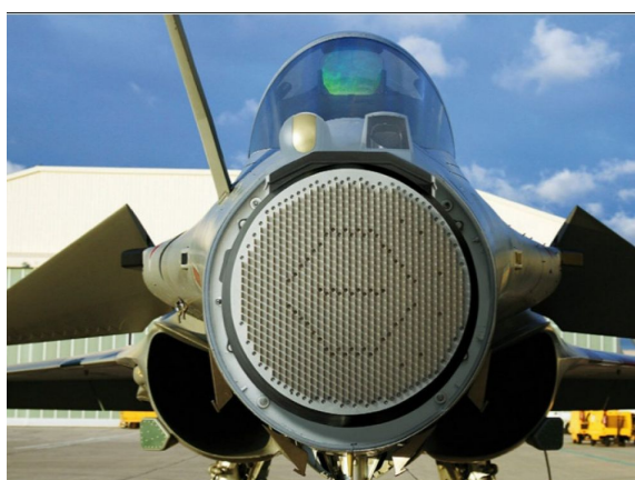
(a) Antenne Radar située dans le nez du Rafale.
