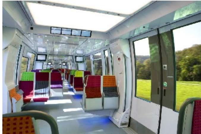
Figure 65. Intérieur d'une NAT, les véhicules d'une rame sont communiquant
