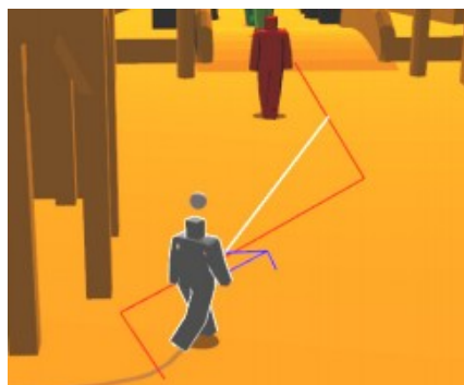
Figure 52. Simulation de SpirOps montrant le système de navigation à trois couches, le chemin A* (en rouge), le Platter Lift (en blanc), et l'évitement des obstacles (flèche bleue)
