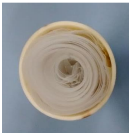
Figure 130 : Echantillon de PE introduit sous forme de rouleau dans le creuset avant un essai
