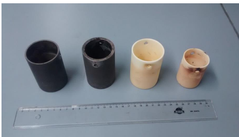
Figure 101 : Photo des creusets. De gauche à droite : creuset inox fin, creuset inox épais, gros creuset céramique et petit creuset céramique
