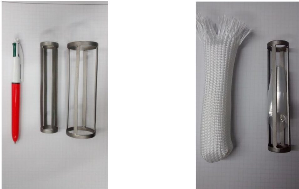
Figure 184 : Photos des armatures et des tissus en fibre de verre. Petite armature : \Phi=2.5\text{cm} et grosse armature : \Phi=4.0\text{cm}
