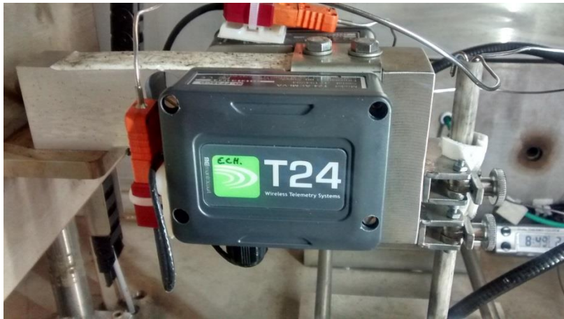
Figure 209 : Transpondeurs fixés sur le peson
