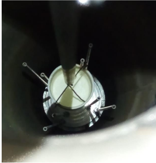
Figure 72 : Dispositif de mesure de températures des gaz à l'intérieur du four
