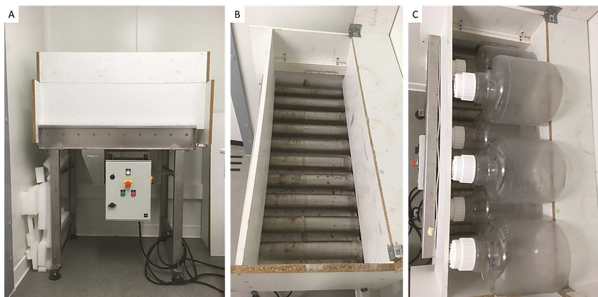
Figure 2-11. Table à rouleaux (A) vue dans son ensemble, (B) vue du dessus et (C) pendant une expérience.
