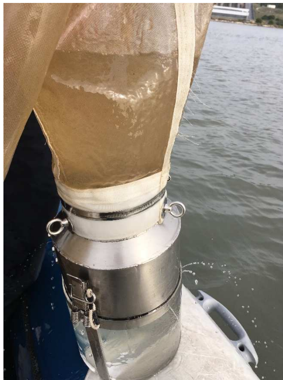
Figure 4-42. Colmatage du filet à gélatineux lors du suivi sur l'étang de Berre.
