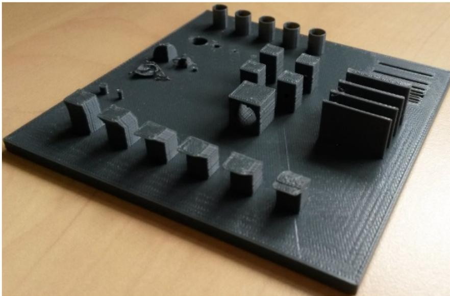
*Figure III-4 : Plaque de qualification imprimée par FDM*
