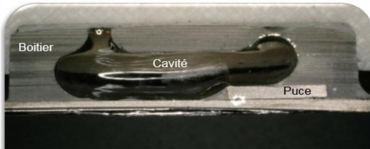
Figure 7 : Vue en coupe d'un démonstrateur fonctionnel encapsulé
