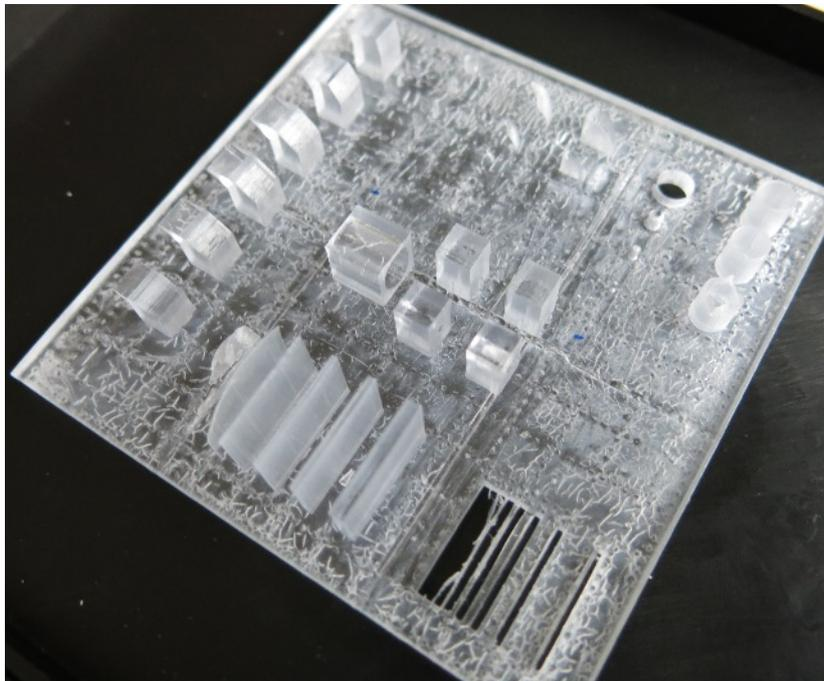
Figure III-2 : Plaque de qualification imprimée par stéréolithographie
