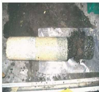
Figure I. 13 Les éprouvettes carottées sur les chaussées dégradées avec les nids de poules [2]
