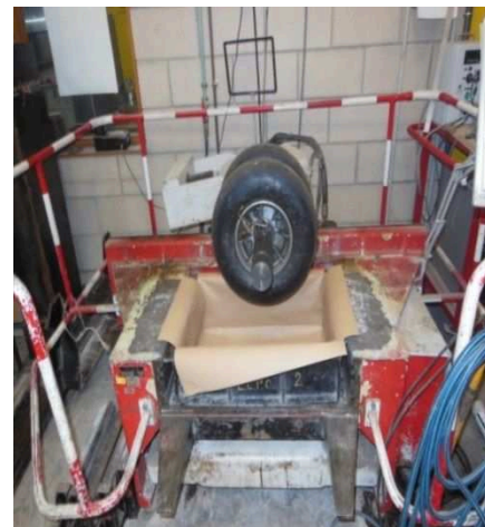
(b) Compacteur à pneus Type BBPAC
