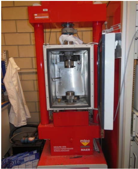
(a) Presse MAER pour l'essai UTST
