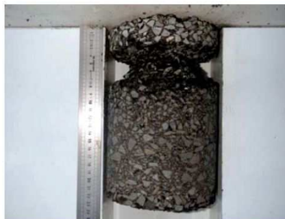
Figure I. 13 Les éprouvettes carottées sur les chaussées dégradées avec les nids de poules [2]
