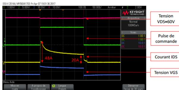
Figure 3.5. Formes d'ondes  $I_{DS}$ ,  $V_{DS}$  et  $V_{GS}$  pendant un pulse.
