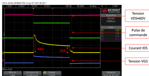
Figure 3.5. Formes d'ondes I_{DS} , V_{DS} et V_{GS} pendant un pulse.
