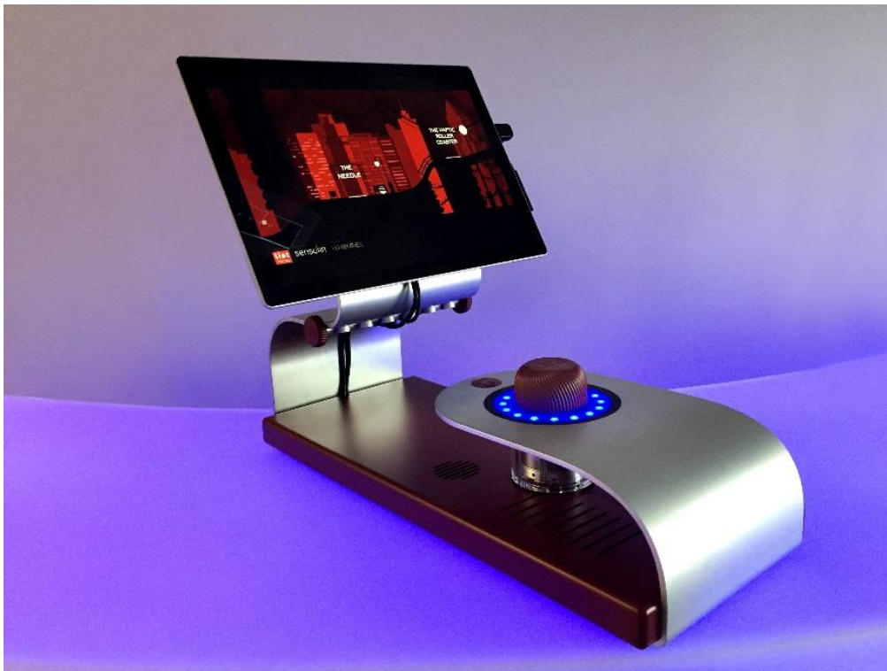
Figure 19 : Interface haptique hybride (frein MR+moteur), MATISS développée par le CEA LIST.
