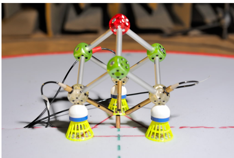
FIGURE 3.3 – Premier dispositif de captation développé, à base de sondes double couche (CMA Cube).
