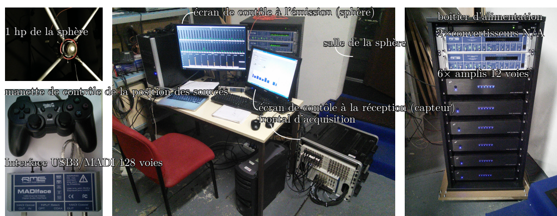
FIGURE 3.19 – Système d'émission (pour la sphère) et d'acquisition (pour le CMA Maki).
