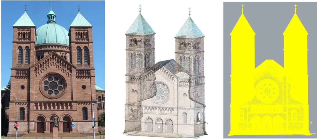
Figure 10. Façade principale de l'Église St-Pierre-le-Jeune, Strasbourg - Nuage de points intégré dans *Revit*, (au milieu) et acquis par scanner-laser terrestre 3D et imagerie drone - Maillage (à droite) réalisé dans l'environnement *Rhino3D*.
