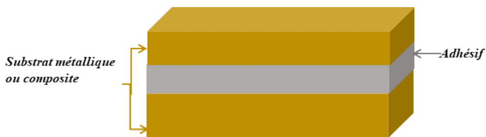
Figure 1-1 : Schéma d'un assemblage collé.
