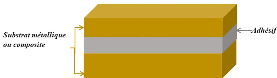
*Figure 1-1 : Schéma d'un assemblage collé.*
