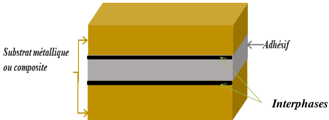
Figure 1-5 : Géométrie du modèle rhéologique aux interphases.
