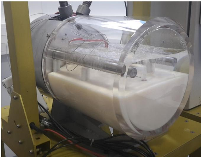
Figure 3. 17. Banc d'essais en pool boiling pendant essai
