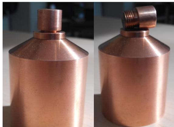
Figure 3. 7. Bloc en cuivre avec surface de 12 mm de diamètre
