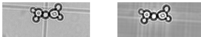
figure 83: Zoom sur un groupe de cellule positionné sur un barreau, avant (gauche) et après (droite) le processus d'effacement de la grille
