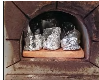
Figure 31 Préparation des échantillons pour la méthode de LOI – février 2017.
