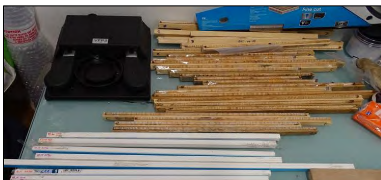
Figure 36 Les carottes préparées sur leur socle et les tubes de prélèvement utilisés pour le séchage – mai 2017.
