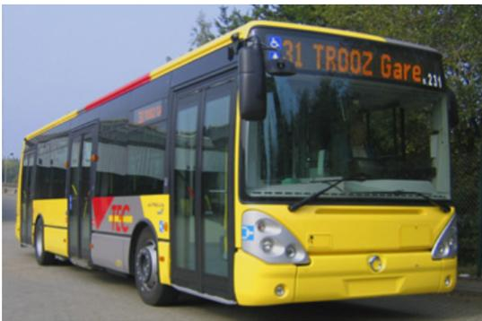
FIGURE 1.2 – Bus Green Propulsion motorisé par une MRVDS (*Green Pro*)
