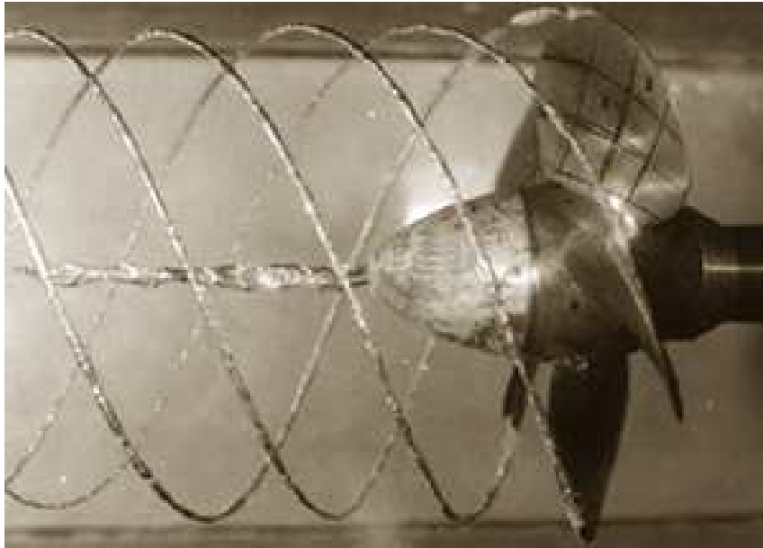
Figure 1.4 – Représentation du phénomène de cavitation sur une hélice [6].
