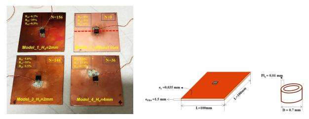
Figure 6: Les différents échantillons avec vias thermiques créés sur un substrat PCB. L'élément chauffant est une résistance brasée. les vias thermiques sont placés au-dessous de la résistance. Un thermocouple est soudé sur la semelle de la résistance pour mesurer sa température au plus près de l'élément chauffant
