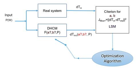
Fig.3-27. Parameters estimation step for DHCM
