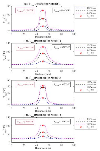
Figure 7: Comparaisons des résultats de simulation et des résultats d'expérimentation. Les températures au milieu de la surface de PCB sont obtenues par simulation thermique 3D. La température de l'élément chauffant est mesurée par thermocouple.
