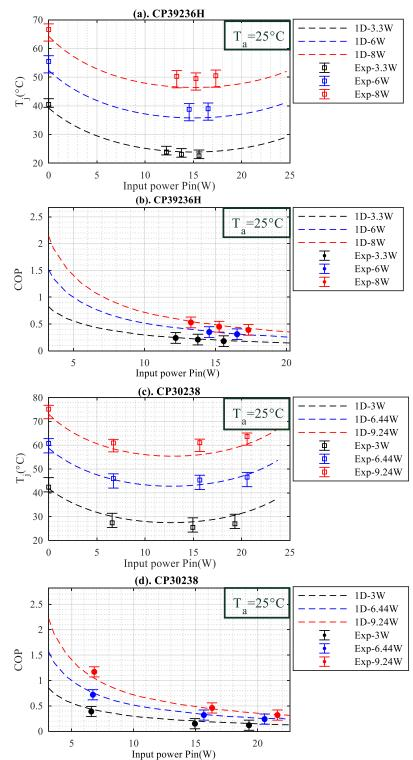
Tout d'abord, le modèle 1D proposé a été validé par comparaisons des résultats de simulation avec les résultats expérimentaux (Voit Figure 12).
