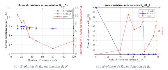
Figure 3: Évolution du rapport de résistance thermique du substrat PCB avec des vias thermiques  $R_{oa}(N)$ ,  $R_{oa}(R_{o1})$
