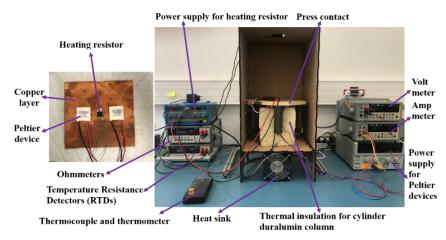
Figure 11: Banc d'essai permettant de mesurer le flux de chaleur par une méthode calorimétrique
