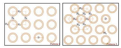
Figure 2: Vue de dessus des deux motifs (Pattern\_1 et Pattern\_2) utilisés pour créer des vias thermiques dans un substrat PCB
