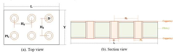
Figure 1: Vue de dessus (a) et vue en coupe (b) des vias thermiques créés dans un substrat PCB
