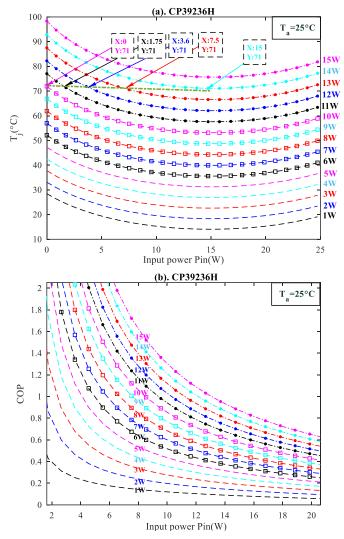
*Figure 13: Résultats prédits à partir du modèle 1D en utilisant les modules Peltier CP39236H. (a). Profil de la température de jonction*  $T_j(P_{in})$ ; *(b). Profil du COP (P<sub>in</sub>). La température ambiante*  $T_a$  *est de 25* °C.
