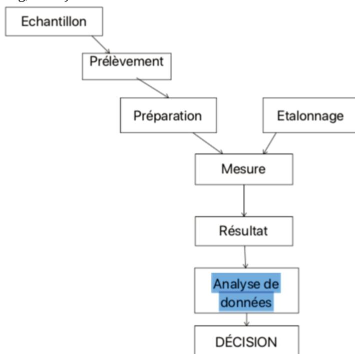
Figure 5-1 Processus de fabrication d'un résultat, d'après (Feinberg, 1996)
