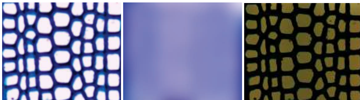
Figure 15. Rehaussement du contraste de l'image par la méthode de Différence de Gaussienne (DoG). A gauche l'image résultante d'un faible DoG ( \sigma = 3 pixels). Au centre, l'image résultante d'un fort DoG ( \sigma = (\text{largeur image})/10 ). A droite, la soustraction des images A et B qui augmente le contraste lumen/paroi. La valeur de l'intensité des pixels de la paroi est nulle.
