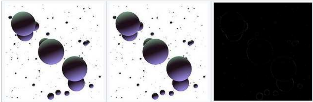
Figure 2.9 Un ensemble de sphères rendues sans gestion du niveau de détail (gauche, 2 328 480 points), avec gestion du niveau de détail (milieu, 109 440 points) et la différence entre les deux images rendues (droite). Crédit image : wikipedia, MaxDZ8.
