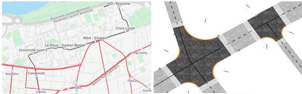
Figure 2.1 Les routes peuvent être représentées à l'aide de lignes (gauche) ou de modèles plus complexes, comme des surfaces (droite). Images extraites respectivement d'Open Street Map et de [Cur16].
