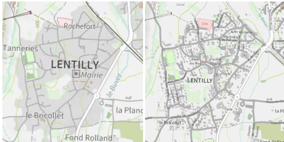
Figure 1.1 Deux cartes du même lieu à différentes échelles (petite échelle à gauche, grande échelle à droite). Plusieurs mécanismes de généralisation sont visibles, dont le remplacement des bâtiments par des tâches urbaines et le déplacement ou la suppression de certains labels. Cartes via IGN et Esri France.
