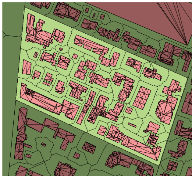
Figure 5.9 Une tuile partitionnée en un ensemble d'empreintes. Exemple issu des données de la Métropole de Lyon. En rouge, les bâtiments et, en vert, leurs empreintes après squelettisation.
