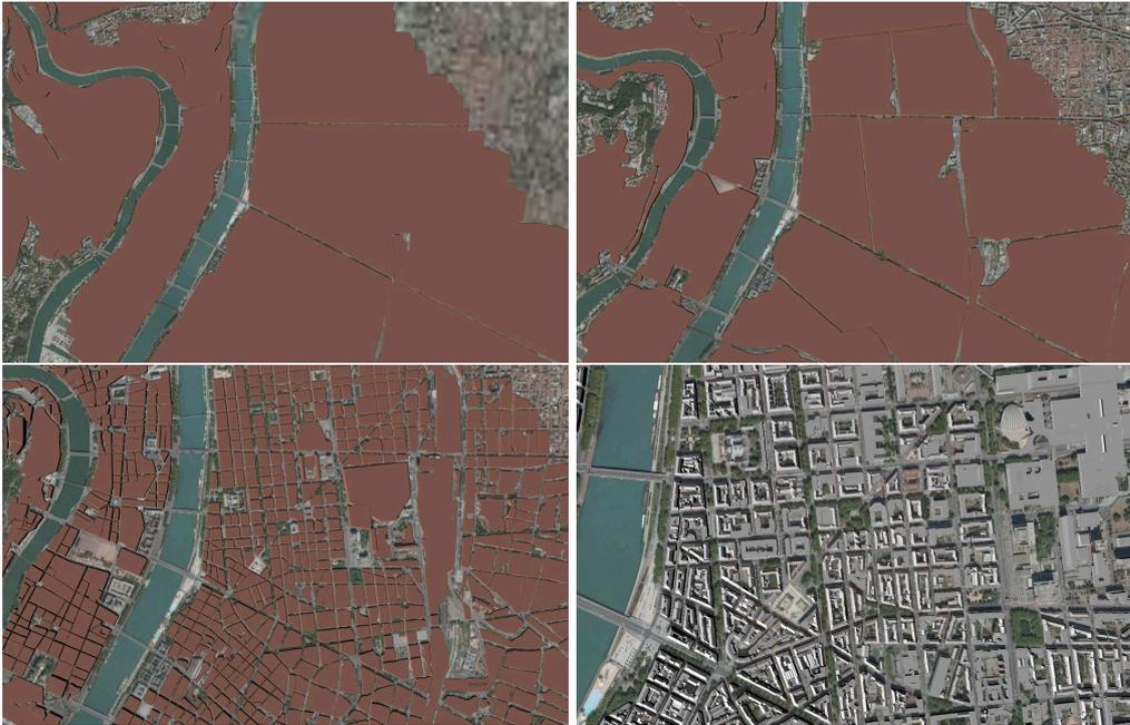
**Figure 4.20** Application de ma méthode de découpage sémantique aux données de la ville de Lyon. Quatre niveaux de zooms successifs, faisant apparaître des tuiles de plus en plus détaillées. Les tuiles de niveau 0 (arrondissements), 1 (quartiers) et 2 (îlots) sont représentées par des formes généralisées, des polygones extrudés. Les bâtiments sont représentés par des maillages.
