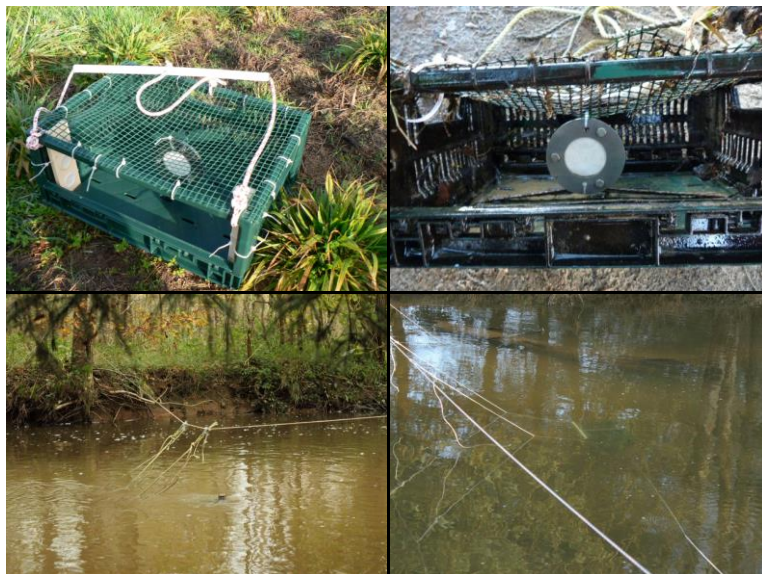
Figure II.29 : Échantillonneurs passifs (POCIS et o-DGT) installés dans une cagette.
