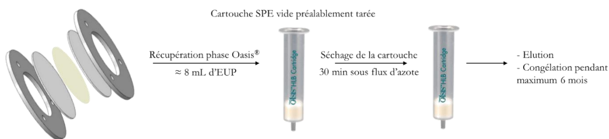
Figure II.6 : Démontage d'un échantillonneur passif de type POCIS.
