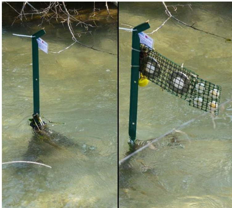
Figure II.27 : Échantillonneurs passifs (POCIS et o-DGT) installés « en drapeau » sur un piquet.
