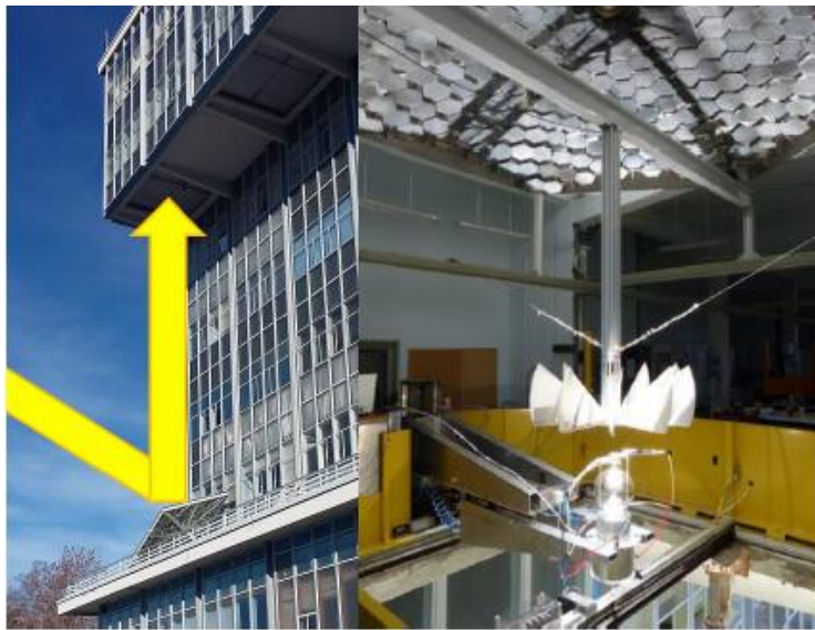
Figure 4.11 : Les deux parties constituant le dispositif expérimental. A gauche, l'héliostat et la trappe, et à droite, le banc d'essai OPTISOL maintenu par un bras mécanisé (en gris) et le concentrateur (en haut). Les photographies sont tirées de la thèse de Mey [Mey 2016].
