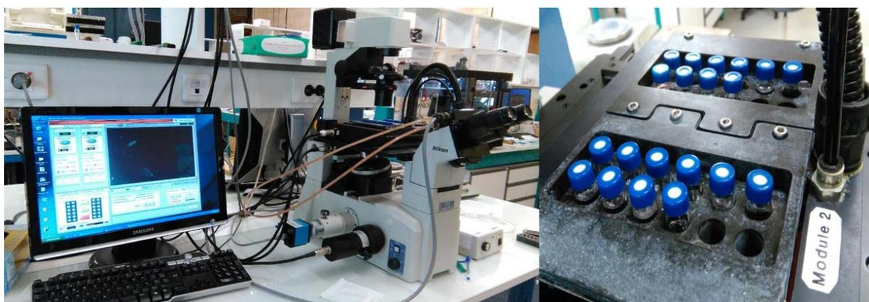
Figure 43. Photographie du Multipuits, à gauche l'ensemble du montage ; à droite les blocs Peltier de 12 vials chacun.
