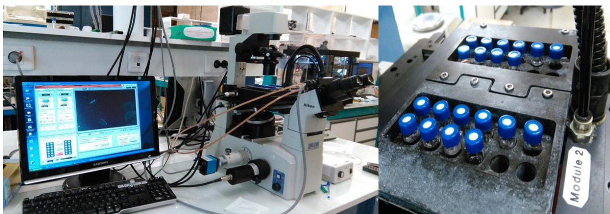
Figure 43. Photographie du Multipuit, à gauche l'ensemble du montage ; à droite les blocs Peltier de 12 vials chacun.
