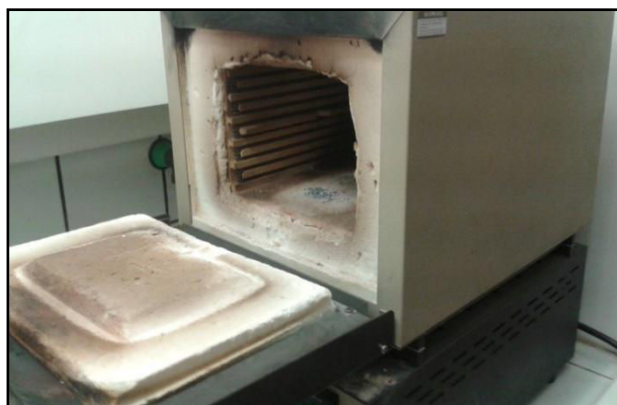
FIGURE 28 - Four à moufle du laboratoire de Rennes 1.
