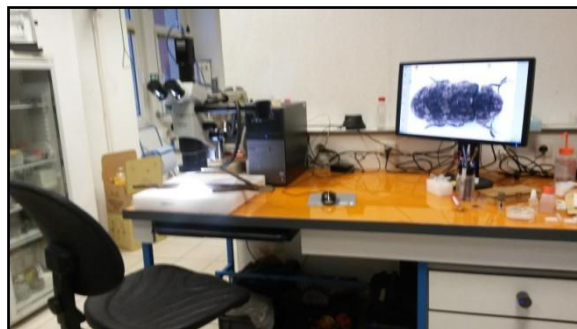
FIGURE 19 - Station de travail au CICRP équipée d'une loupe binoculaire, reliée à un analyseur d'images.
