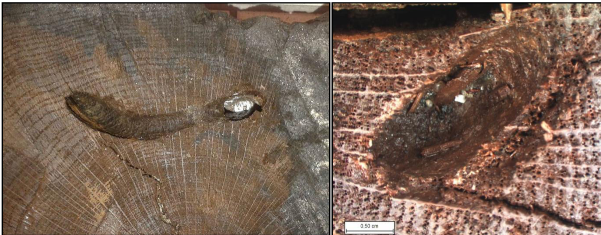
FIGURE 160 - Échantillon de la contre-fiche 44638 avec galeries de type Cerambyx cerdo .
