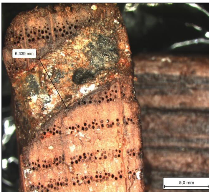
FIGURE 156 - Dessin de répartition des galeries ovales du pieu 40901.12 (134) sur l'ensemble de la pièce et mise en corrélation avec l'échantillon photographié, cl. L. GANTIER, DAO M. TORITI).
