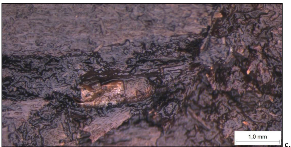
FIGURE 155 - a. Vue des galeries situées dans le cambium, en tangentielle. b. Vue d'un insecte coincé dans une galerie et vermoulure associée. c. Exemple d'un autre insecte bloqué dans une galerie, visible du dessus.
