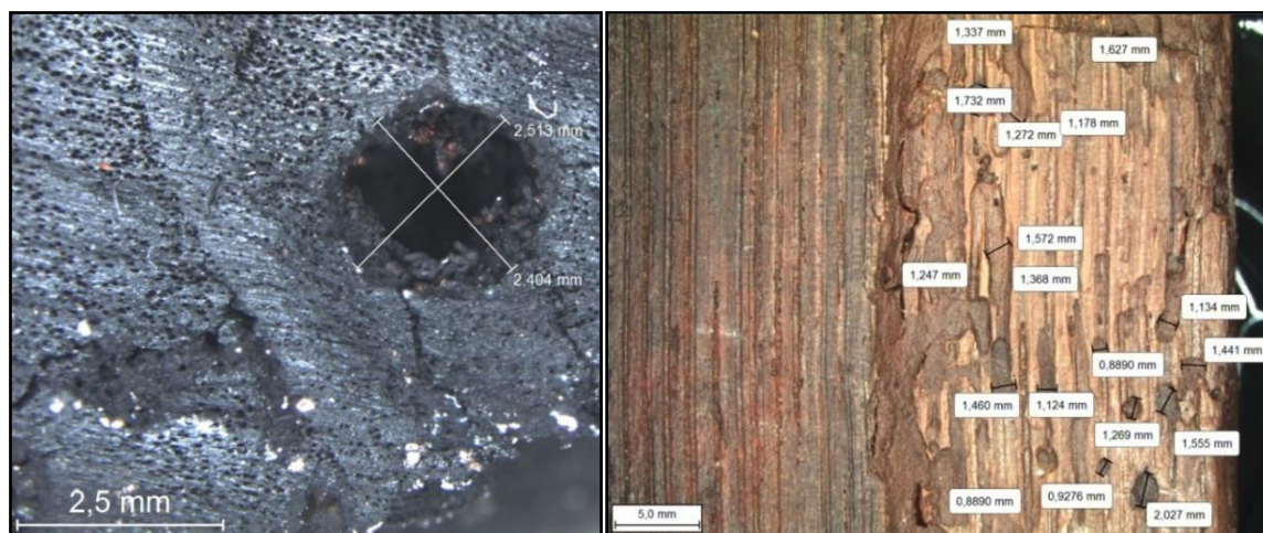
FIGURE 20 - Exemples de mesures de galeries sur charbon de bois (gauche) et sur bois gorgé d'eau (droite), sur un plan transversal et sur un plan longitudinale tangential, sites : îlot Camelin (83) et Rezé (44).
