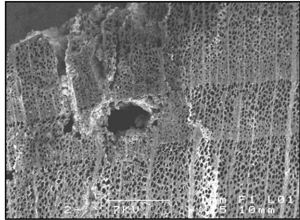
FIGURE 177 - Galerie d'insecte xylophage sur du hêtre ( Fagus sylvatica ), structure 3775, cl. CMEBA.
