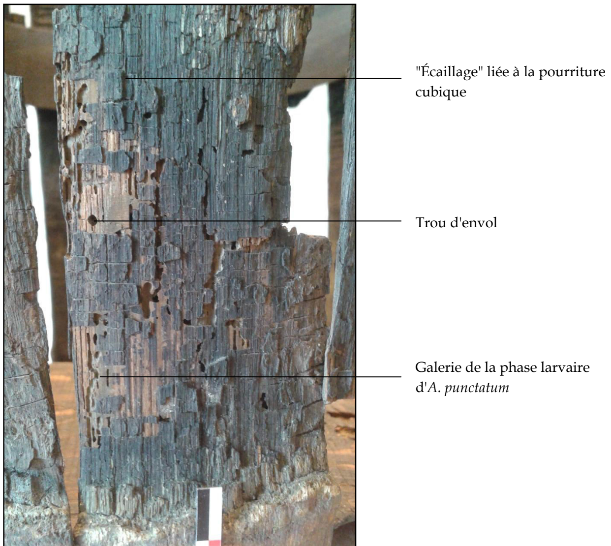
FIGURE 250 - Seau 930.2.4759, détails de la douelle n°6.
