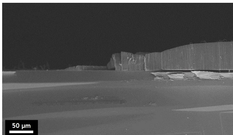
Figure A26 Images MEB en coupe d'un échantillon Si/VACNTs lorsqu'une couche PVD d'Al est présente : partie droite du cliché MEB
