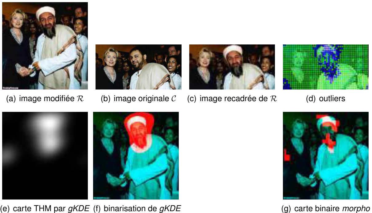
FIGURE 5.17 – Exemple de résultat de la méthode de détection et localisation de modifications. Dans (d) : les outliers sont en bleus et les inliers en vert.
