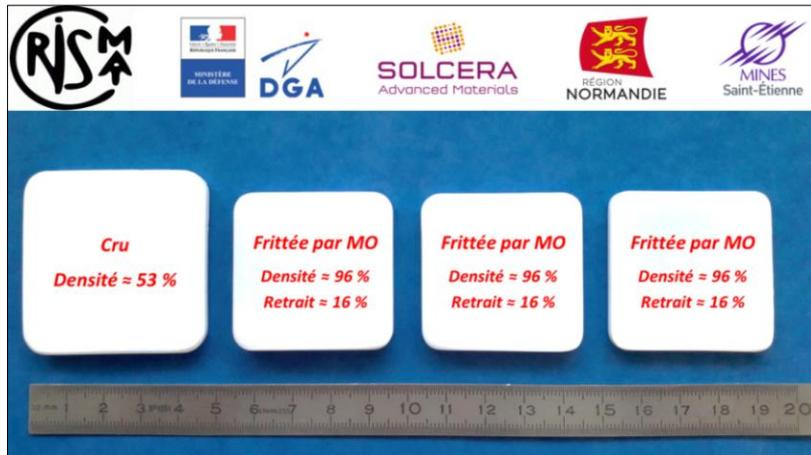
Figure 84 : Photographie des échantillons frittés au sein du four micro-ondes monomode 915 MHz
