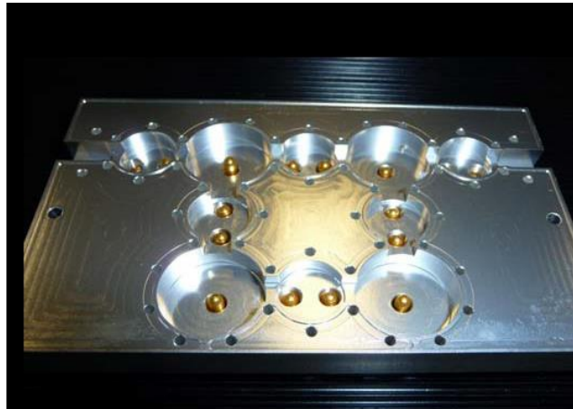
Figure 18 : Photographie d'un filtre présentant des couplages par nœuds non-résonants [35].
