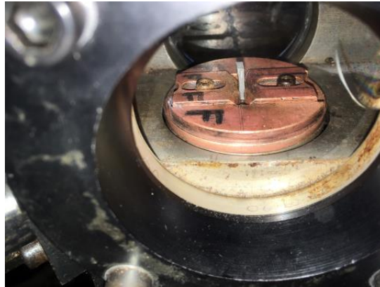
Figure 39 : Image du banc de combustion CHAMADE avec un échantillon de propergol
